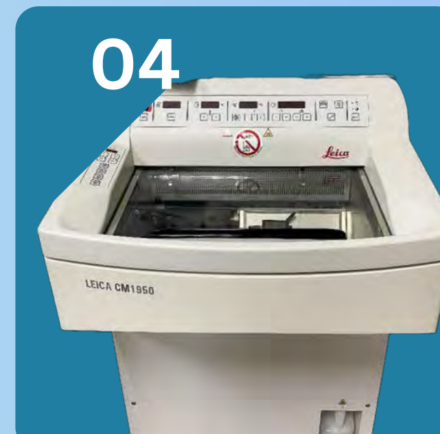
微電腦雙溫冷凍切片機
